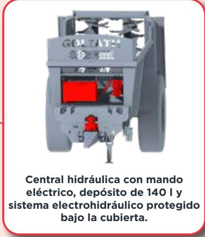
Central hidráulica con mando eléctrico, depósito de 140 l y sistema electrohidráulico protegido bajo la cubierta.
